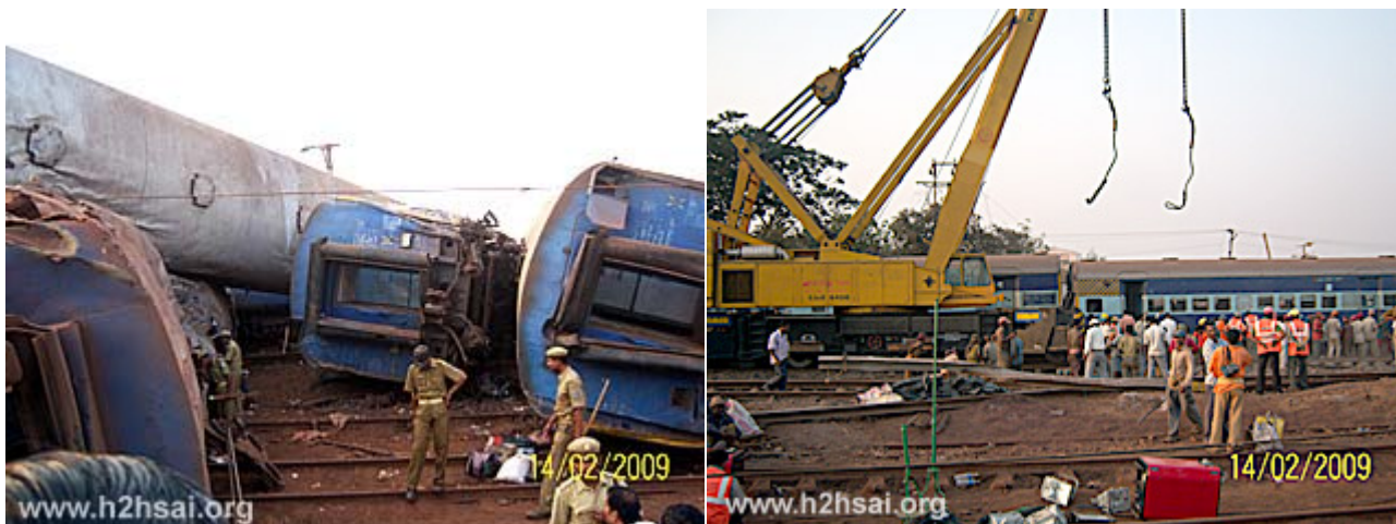
Außerstande, dem Stoß des plötzlichen Stopps zu widerstehen, überschlugen sich die Wagen S4 und S5 einfach, während viele andere Anhänger sofort entgleisten.
